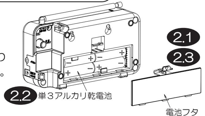
⚠ 注意：電池灯が3秒に1度の間隔で点滅した時は、電池が入っていないか、電池が消耗しています。新しい電池に交換してください。電池は1年程度が交換の目安となります。電池が消耗していなくても、定期的に交換をお願いします。
