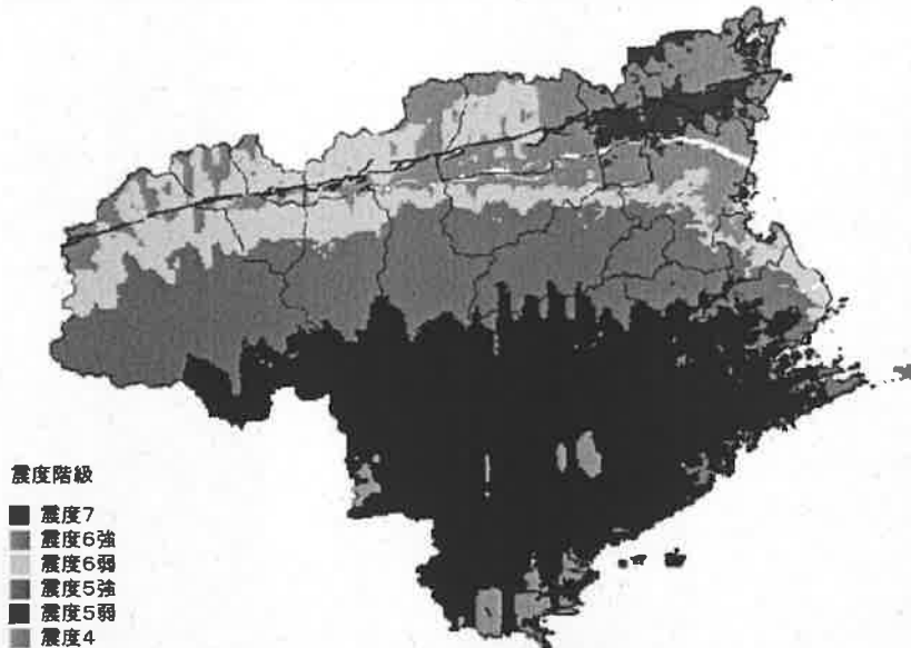
図表 中央構造線・活断層地震による震度分布図（徳島県想定）
