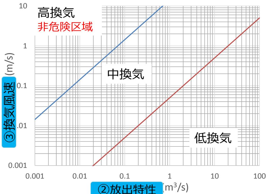
放出特性と換気風速(屋外or屋内は換気量より算出)
