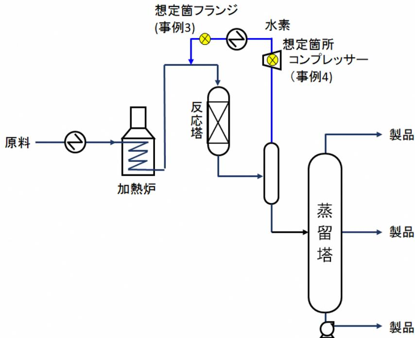
図 5.2 高圧系の重油脱硫反応塔へ水素供給する閉ざされた配管のフランジ部とコンプレッサー摺動部の危険区域のリスク評価
