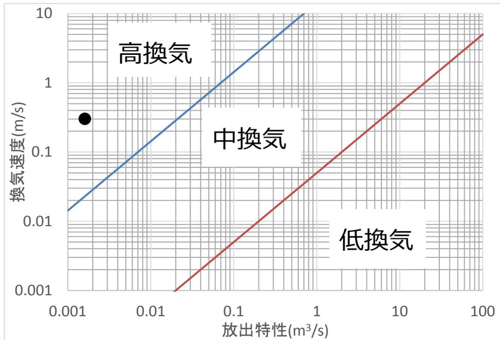
図 5.4 換気度 (事例1) 溶剤蒸留工程 (シクロヘキサン、ガス放出)
