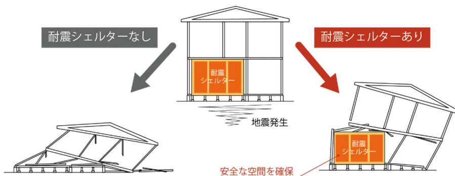
図 2-4 耐震シェルターの設置イメージ
