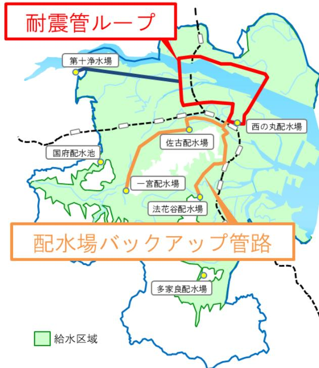
図 3.11 耐震管ループ及び配水場バックアップ管路
