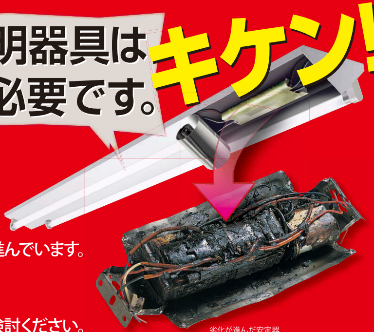
劣化が進んだ安定器
